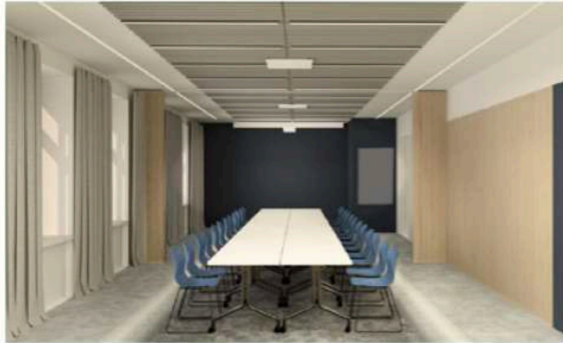
Lielā apspriežu telpa - linijveida profila tipa gaismekļi starp listēm un iestrādāti griestos vispārējam telpas nogaismojumam
